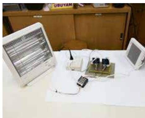
写真5 脱衣所の自動温度調節装置
