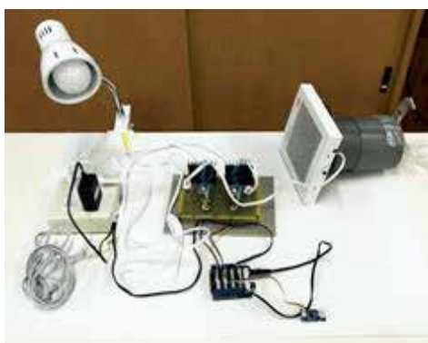
写真4 トイレの自動点灯・換気システム
