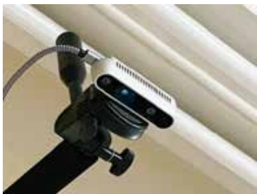
写真3 天井近くに深度センサーを設置
