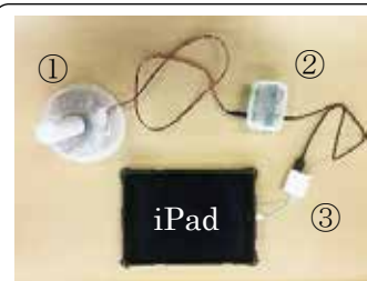
写真 2 ①棒状スイッチ ②スイッチアダプタ ③LightningUSB アダプタ
