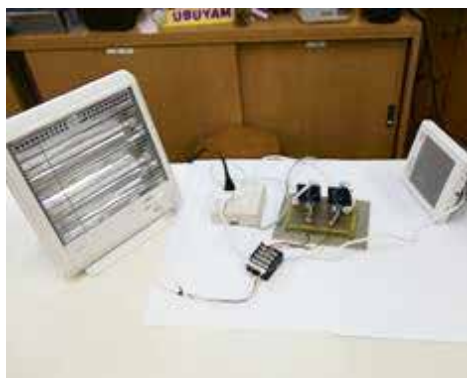
写真5 脱衣所の自動温度調節装置
