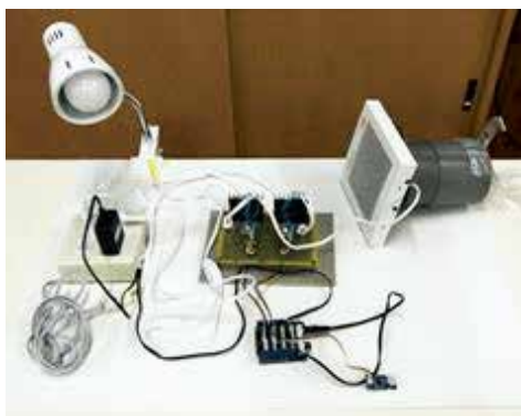
写真4 トイレの自動点灯・換気システム
