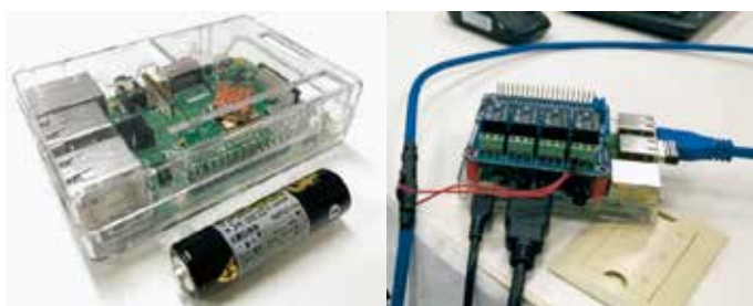
写真2 RaspberryPi 3B+とリレーモジュール
