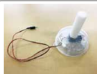
写真 1 棒状スイッチ （既製品） 倒すと ON になる
